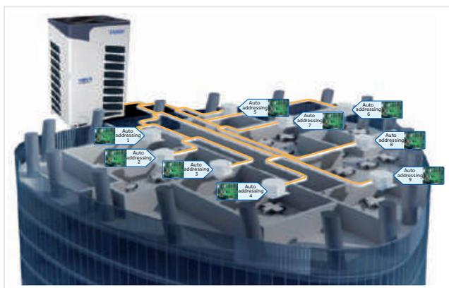
Un nuovo sistema automatico di indirizzamento digitale delle unità interne, riduce i tempi di messa in servizio dei sistemi
